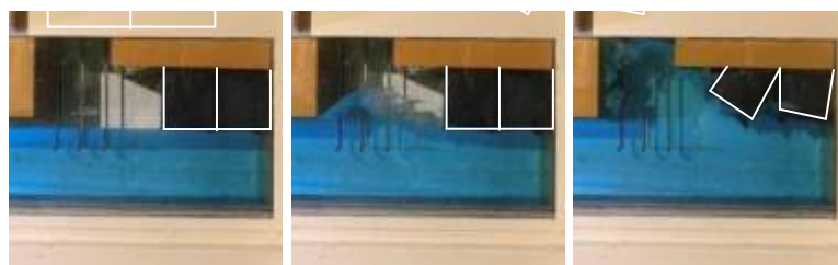
写真-2 水路実験の様子(エアバッグ4個)
