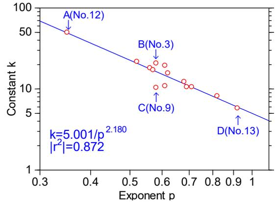
図 1 対象洪水の最適パラメータ
