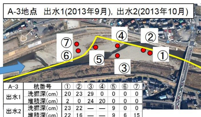
図-2 A-3 地点の2回の出水前後での観測結果(粒度分布は出水2後に調査、下層は表層から20cm下まで)
