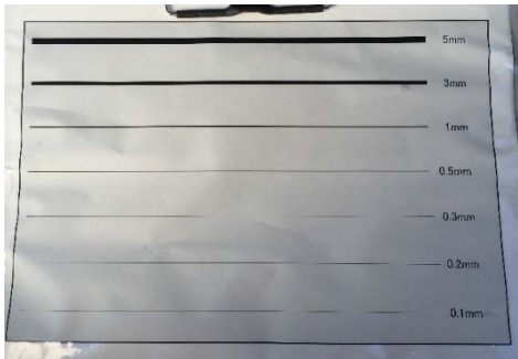
写真-3 クラック幅認識テストペーパー
