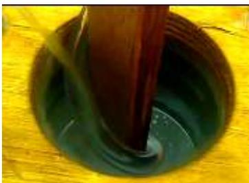
写真1 鉛直管に螺旋チューブを挿入したことによって螺旋渦が形成されている状態
