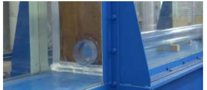
写真3 塩ビ管上流端の接続状態(張り出した状態)
