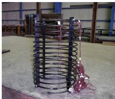
写真-1 治具取付後の内巻き帯鉄筋
