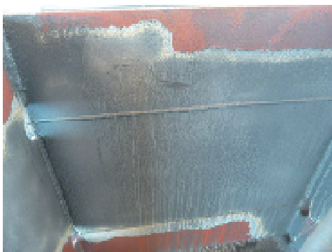
図6. 微霧噴出量1.16kg/min.以上でブラストした後の鋼材表面
