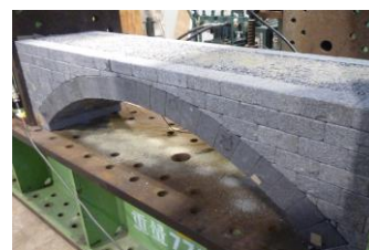
写真 1 壁石と内部砂の様子
