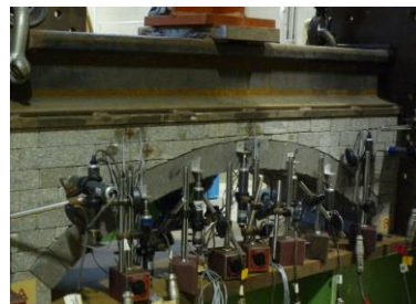
写真 3 壁石を含む載荷実験の様子
