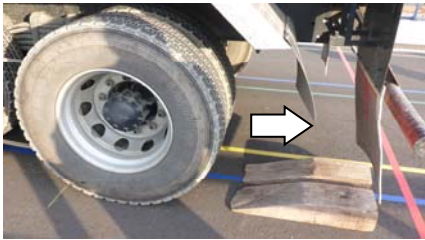
写真-1 踏み台落下試験状況
