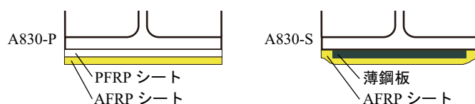
図 2 A830-P, A830-S 試験体の補強概要に関する断面図
