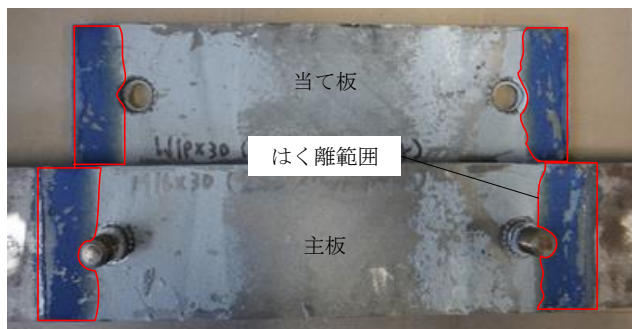
図-6 試験体 AS-s の接合面のはく離範囲
