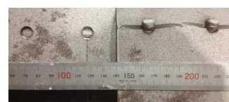
写真-1 V2-02 ねじ・鋼板破断
