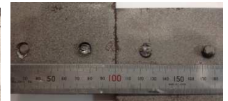
写真-2 V2-05 ねじ破断
