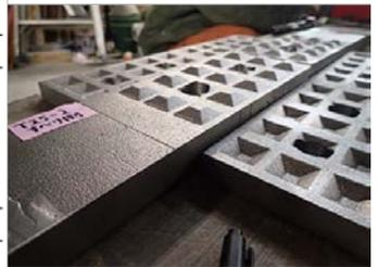
図-3 接合面の凹凸
