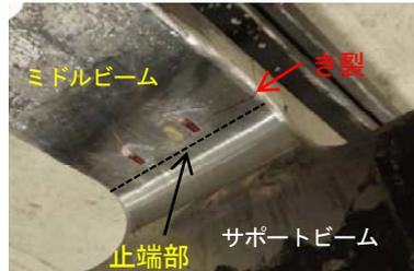
写真3 RF3試験体のき裂
