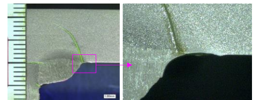
(b) 止端き裂が進展した試験体
