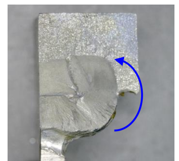
図 9 No. 2R の疲労破面
