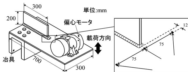
図-1 試験体寸法
