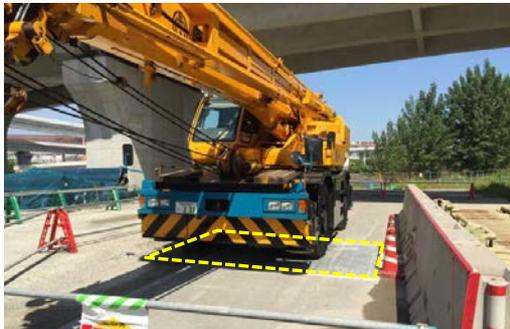
写真-1 載荷試験状況 (床版設置直後)
