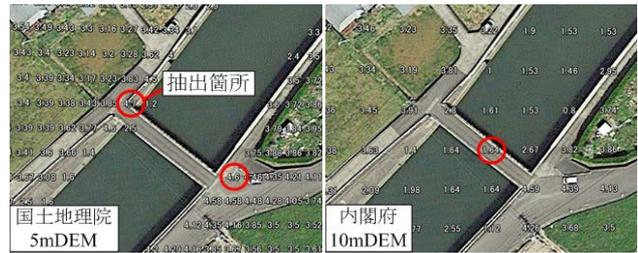
図-3 橋台両端標高および河床標高の抽出箇所の一例
