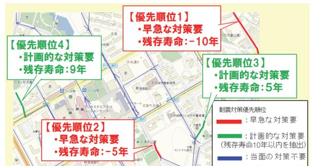
図-3 耐震性評価結果の表示イメージ
