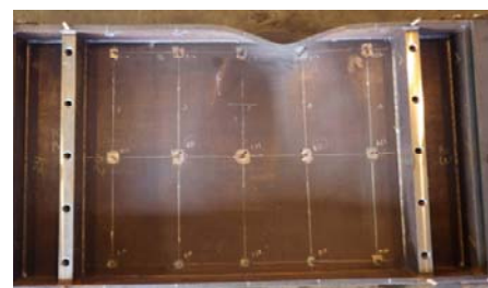
写真-2 試験後の変形状況(SBHS400)
