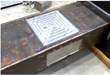
図-1 模擬腐食導入部(試験体A2)
