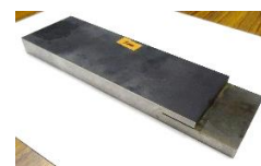
図-1 音圧分布計測試験体
