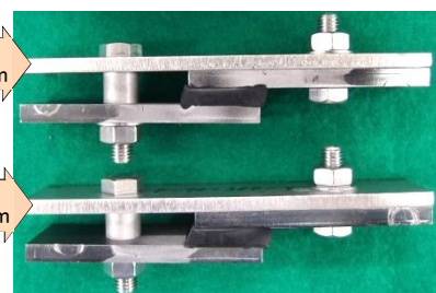
写真-1 引張せん断試験ひずみ付与
