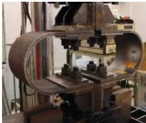
写真-1 疲労試験の実施状況
