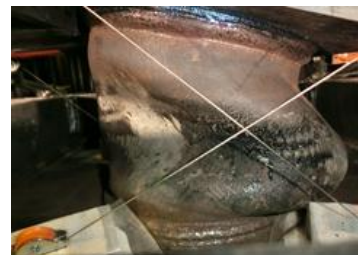
写真 - 2 頭部固定無し 試験後変形状況
