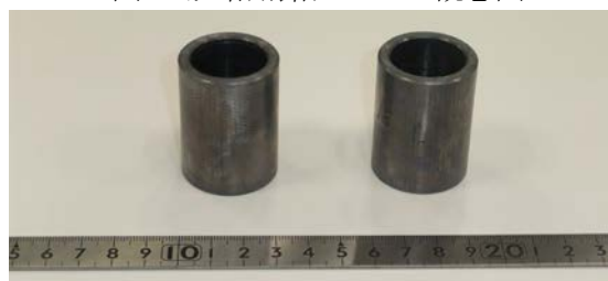
図-2 ボルト孔に充填したリング状の鉛
