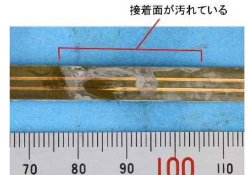
写真-4 劣化分析
