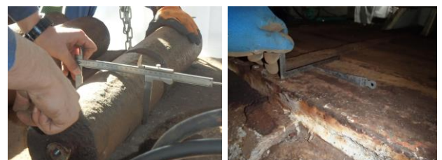
写真-4 ローラーの測定状況(左: ローラー 右: 下沓)
