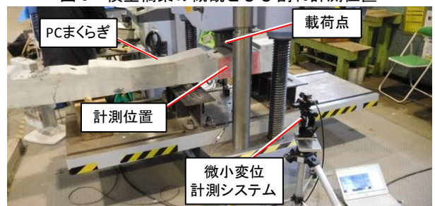
図4 PCまくらぎの曲げ破壊試験の状況
