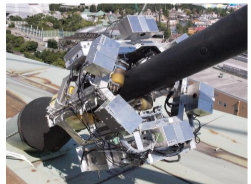
写真-2 ケーブル点検ロボット
