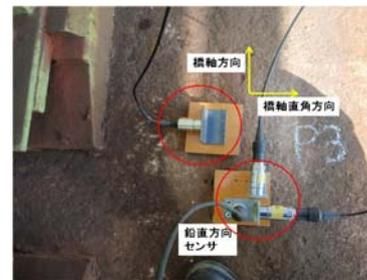
写真-1 センサ設置状況
