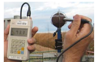
写真-1 さび厚計測状況
