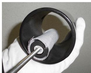
写真-2 付着塩分採取状況
