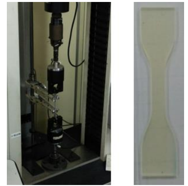
写真 3. 左：試験機外観 右：試験体外観
