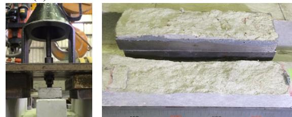
(b) 下面リブの試験状況および破断状態
