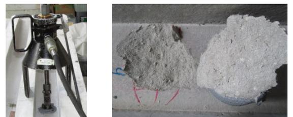
(a) 平板部の試験状況および破断状態
