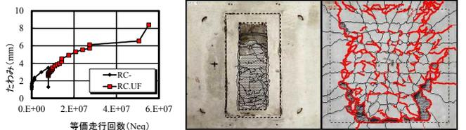
(2) 破壊時のたわみ・ひび割れ状況
