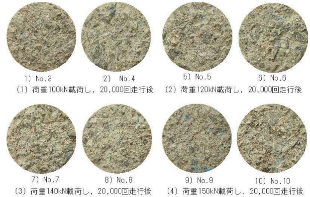
図-3 建研式引張試験による破壊面
