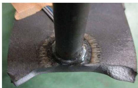
写真-2 試験体の破断状況
