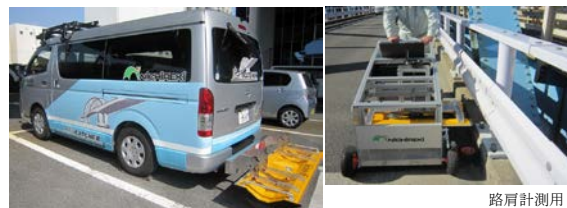
写真-1 床版キャッチャー
