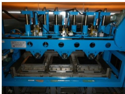
写真-2 ホイールトラッキング試験状況
