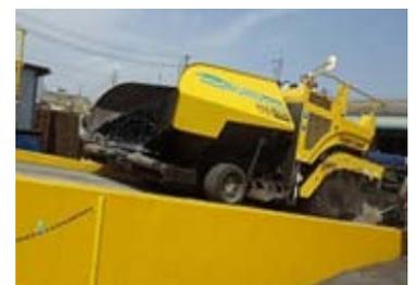
写真-1 勾配箇所におけるせん断力測定状況
