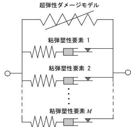
図-2 ゴムの超弾性-粘弾塑性ダメージモデル
