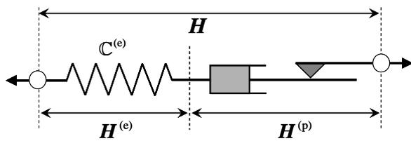
図-1 粘弾塑性モデルの概念図
