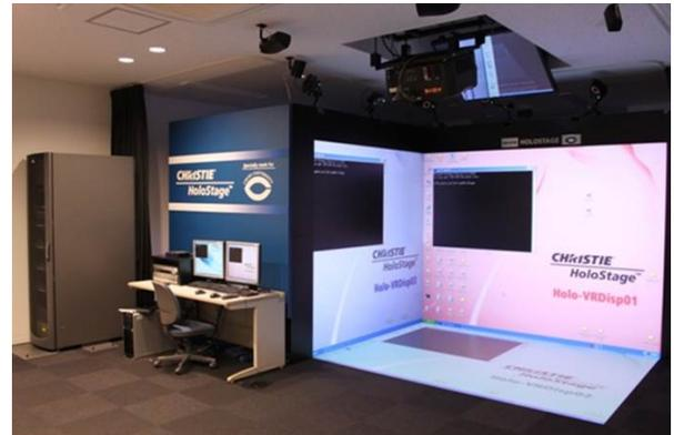
図-1 没入型 VR 装置 HoloStage
