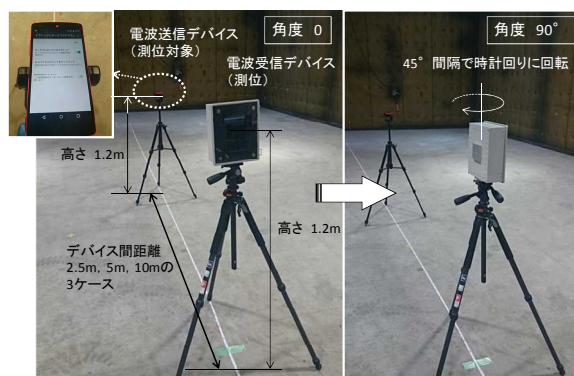
図-3 通信電波強度計測実験状況
