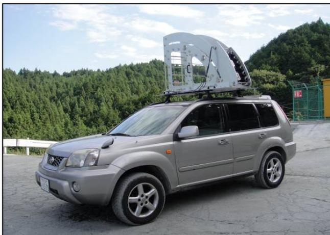
写真-1 走行型撮影装置【分解可搬型】
