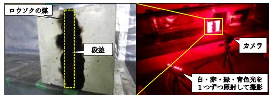
図-7 煤を付着した段差供試体(左)と実験状況(右)
