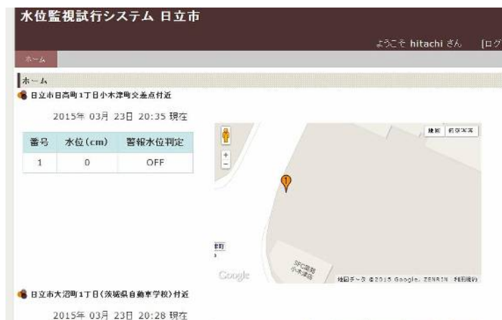
図-5 内水氾濫監視システム (Web サイト画面例)
