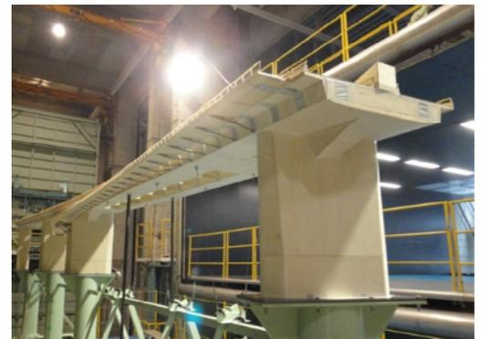
図-5 添架歩道橋風洞試験
