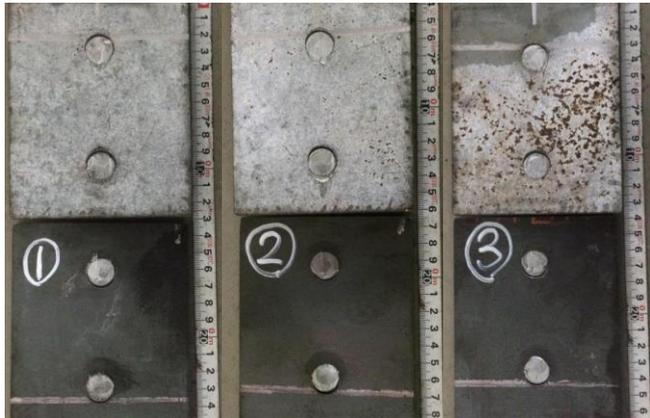
写真2 破断後の2本TRS試験体
